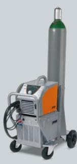
Durch das robuste Fahrwerk mit großen, leicht laufenden Rädern lassen sich die Geräte problemlos in der Werkstatt und auf der Baustelle manövrieren und transportieren. Sie sind auch für den Kran- und Staplertransport geeignet. Der Fahrwagen ermöglicht zudem die Aufnahme einer 50-I-Gasflasche.
