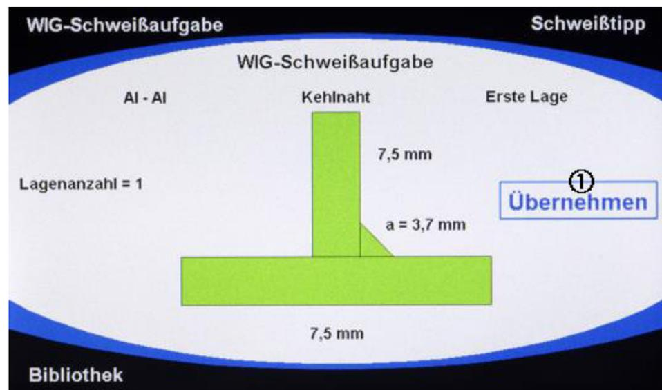
Abb. 37: Bedienfeld INVERTIG.PRO digital / Applikation Assist
