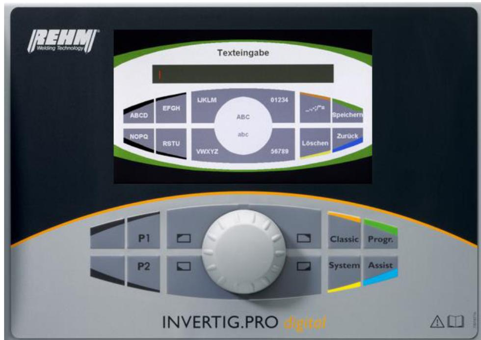
Abb. 28: Bedienfeld INVERTIG.PRO digital / Applikation Programme (Progr.)
