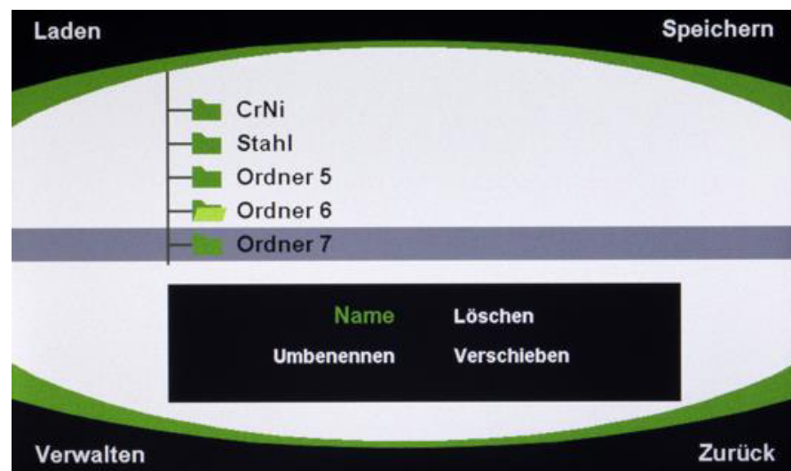
Abb. 26: Bedienfeld INVERTIG.PRO digital COMPACT / Applikation Programme (Progr.) / Verwalten vorhandener Ordner
