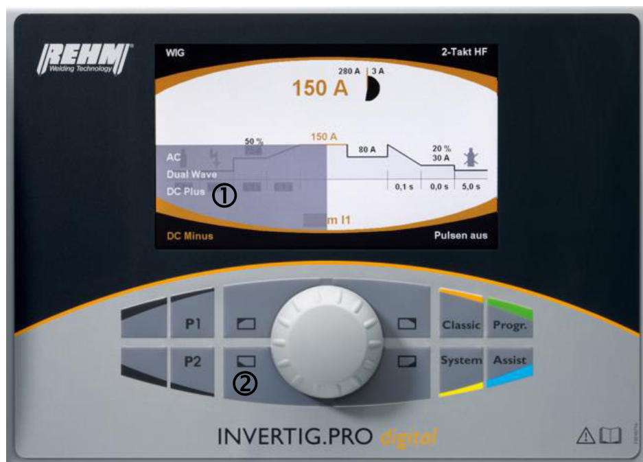
Abb. 3: Bedienfeld INVERTIG.PRO digital COMPACT / Applikation Classic
