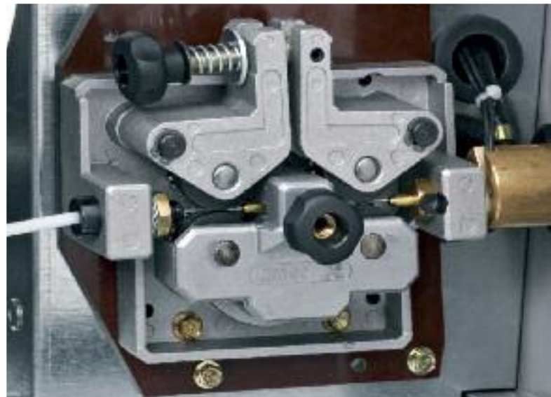
Kraftvoller 4-Rollen-Antrieb für Feinschweißarbeiten an Dünoblech
